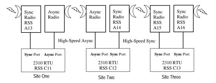
FIGURE 8. EXAMPLE OF HIGH-SPEED ASYNCHRONOUS HOP
