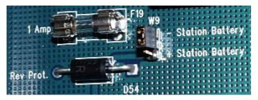
FIGURE 5. BATTERY POLARITY SELECT FOR OPTOISOLATORS
