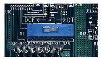
FIGURE 6. DCE VERSUS DTE SELECTOR SWITCH
